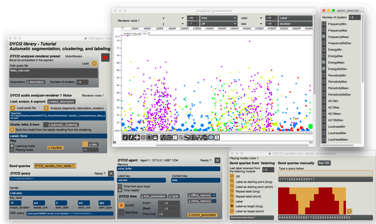
Figure 1. Exemple de patch tutorial utilisant les objets de la librairie : 1 agent embarquant un modèle appris sur l'analyse automatique d'un fichier audio, un module de requêtes manuelles et requêtes provenant d'une écoute réactive d'un flux audio analysé en temps réel, un module de restitution audio basé sur le moteur CataRT (exemple issu de l'utilisation de la librairie DYCI2 par le saxophoniste Rémi Fox lors d'une performance à l'Académie de Darmstadt, juillet 2018).
